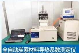
全自动炭素材料导热系数测定仪
